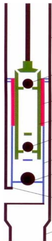
Противопесочный насос с удлиненным плунжером
